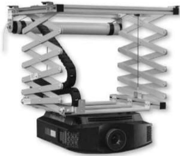
L'ascenseur pour vidéoprojecteur VP225 est idéal pour dissimuler son vidéoprojecteur dans un faux plafond. Simple à installer et à utiliser, il supporte jusqu' à 25kg de charge et possède des butées de réglages électroniques pour son positionnement. L'ascenseur VP225 est équipé d'un moteur cylindrique fiable et extrêmement silencieux permettant un débattement de 23cm à 196 cm.
